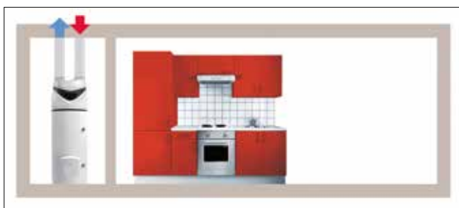
LUCHT AAN EN AFVOER VIA DE BUITENLUCHT OM DE BINNENRUIMTE NIET AF TE KOELEN
