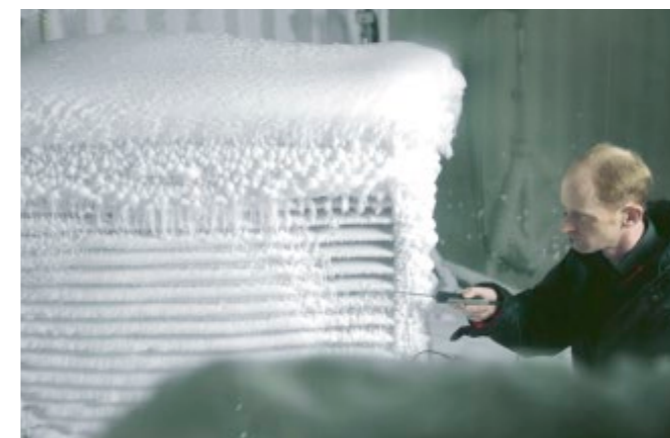
In de klimaatkamer worden de units in extreme weersomstandigheden in werking gesteld en getest.
