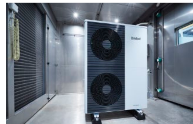
Testteams testen de buitenunit in de klimaatkamer.
